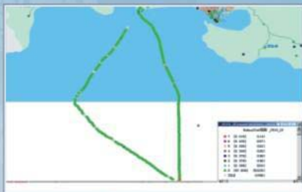
安装基站放大器后的信号路测图 (实际覆盖距离已超过32Km)
